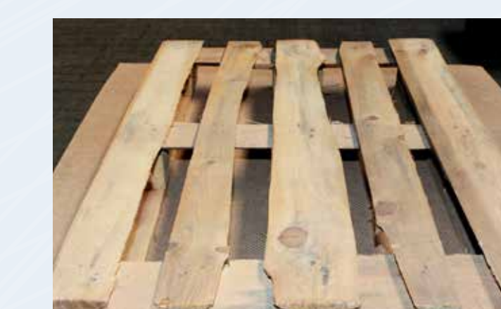
Unzulässiges Bauteil, z.B. untermäßig, morsch, Baumkante
