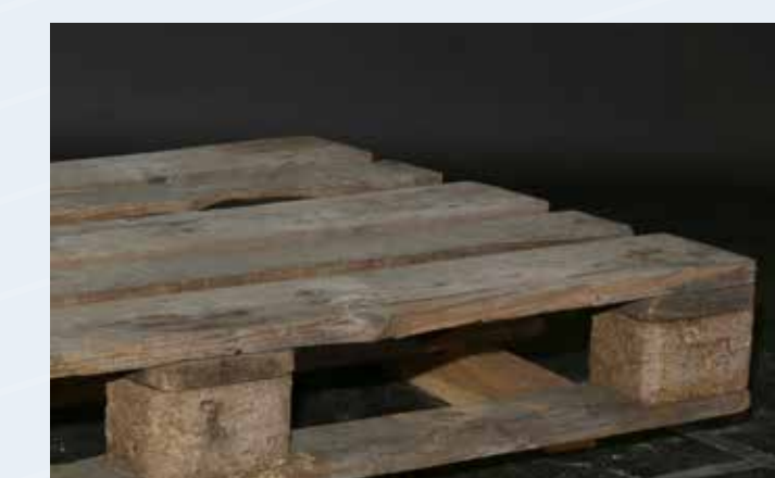
Keine vorgeschriebene Kennzeichnung mehr lesbar
