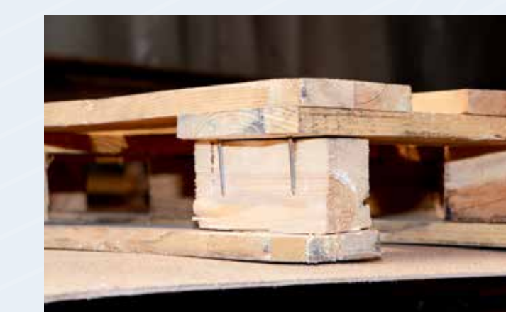
Sichtbare Befestigungselemente z.B. Nägel
